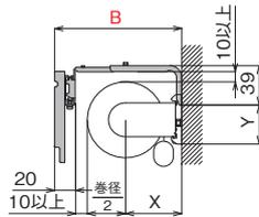
※X=コントロールユニット I (51 mm)・II (61 mm)・III (69 mm)
