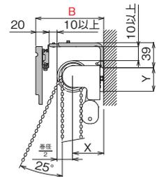
※X=コントロールユニット I (51 mm)・II (61 mm)・III (69 mm)
