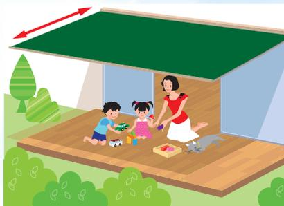
夏は大きい日陰を作り、室内への日射熱の侵入を低減。冬はキャンパスを収納して室内へ日射熱を採りこむことができます。
