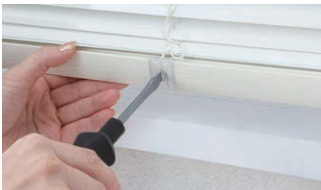
ボトムレールの高さ調整ダイヤルで調 整。90度ずつ回して微調整します。
