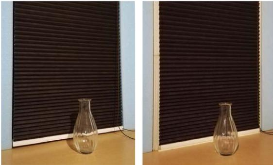
60分後、隙間から入ってくる冷気により、温度が低下していきますが、サーモブロックタイプは標準タイプに比べ、温度低下が少ないことがわかります。
