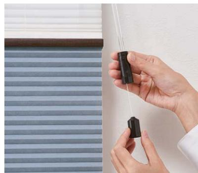
操作棒の切替えグリップを回して昇降と調光の切り替えを行い、切替えグリップ下のコード止めを引いて生地の上げ下げの操作をします。
