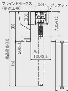
○商品高さ(H)はスラット水平時を表します。全閉時は、テクニスト25が約20mm、テクニスト35・50が約25mm下がります。(全閉時はスラット凸面が屋外側)
